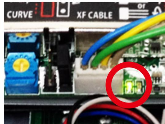
9) 両端のコネクタを接続したら接続チェックを行います。ミキサーの電源を入れて下さい。(電源を入れたら基盤等に手を触れないようにお気をつけください) コネクタが逆に接続されているとランプが赤くつきます、本体電源を切り接続し直して下さい。正しく接続されると緑のランプが光ります。
