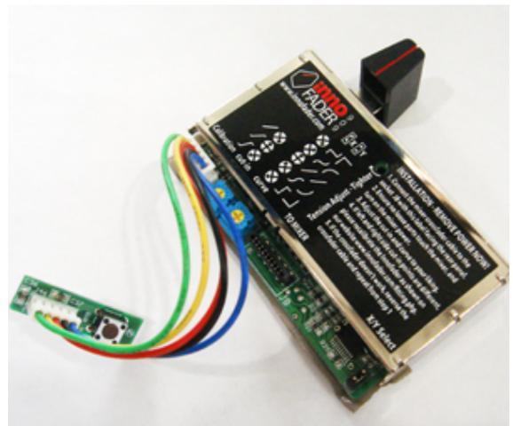
設定が完了したらキャリブレーションアダプタに有るキャリブレーション・ボタンを一度押し、ミキサーの電源をOFFにして下さい。設定が記録されます。
